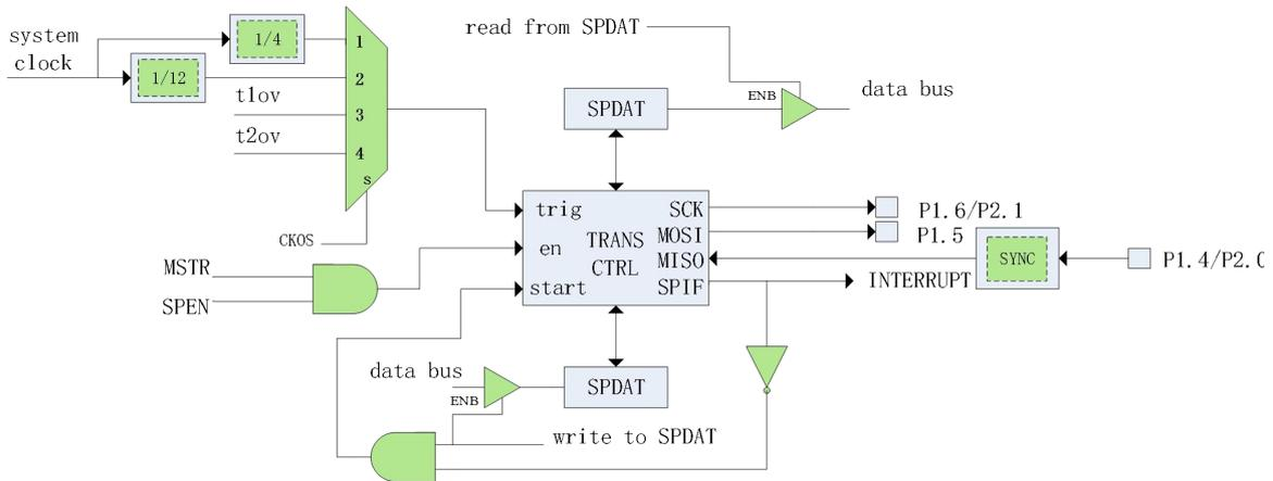
图 19-1-1 SPI 主机模式示意图
