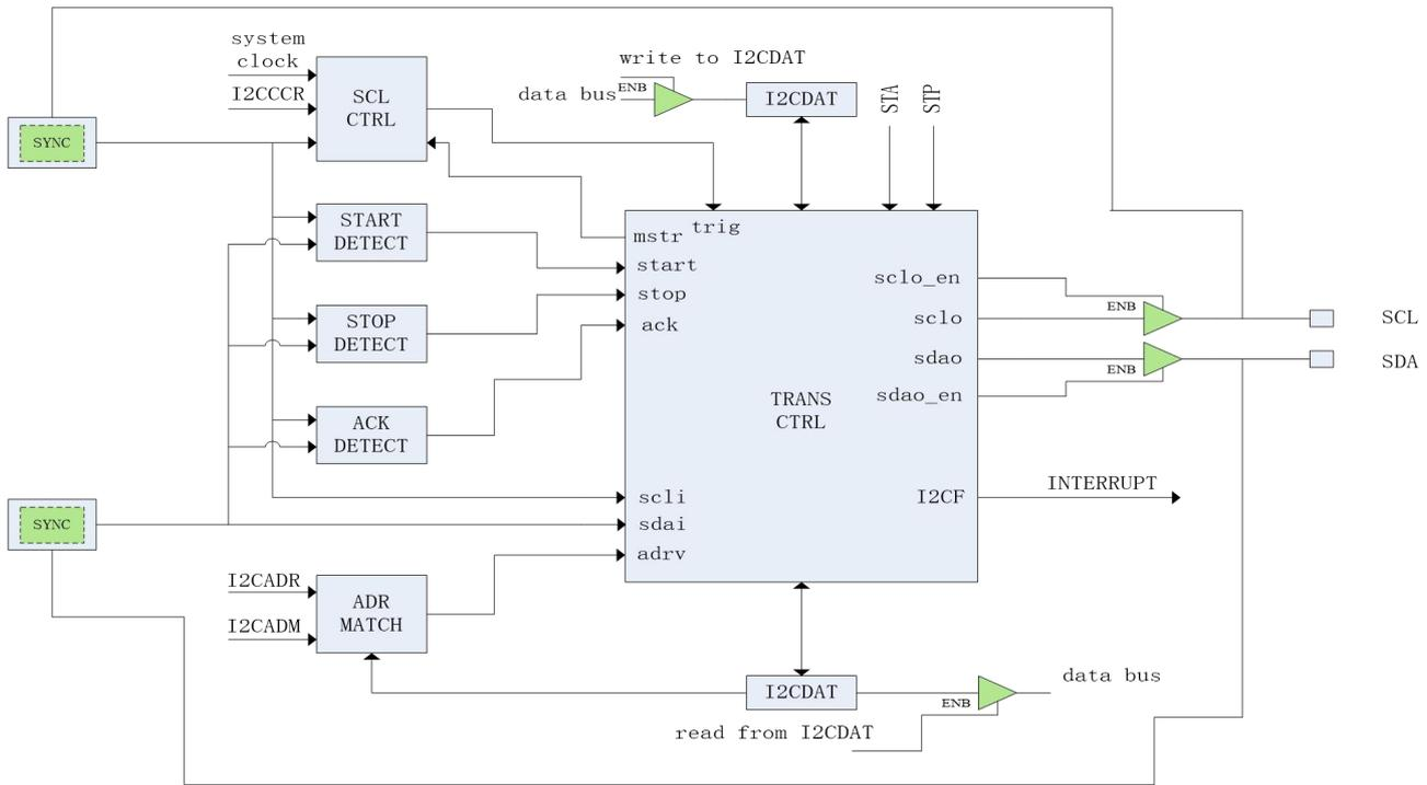
图 17-3-2 I<sup>2</sup>C 模块原理示意图
