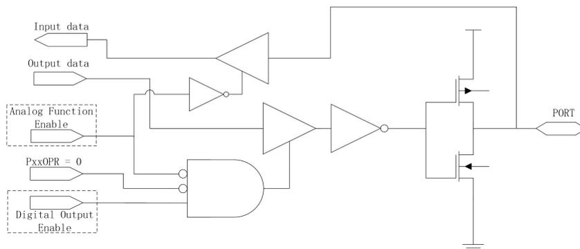
图 15-1-1 I/O 推挽模式结构示意图
