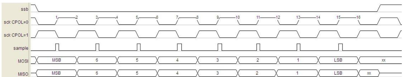
图 19-1-3 CPHA=0 时 SPI 时序图
