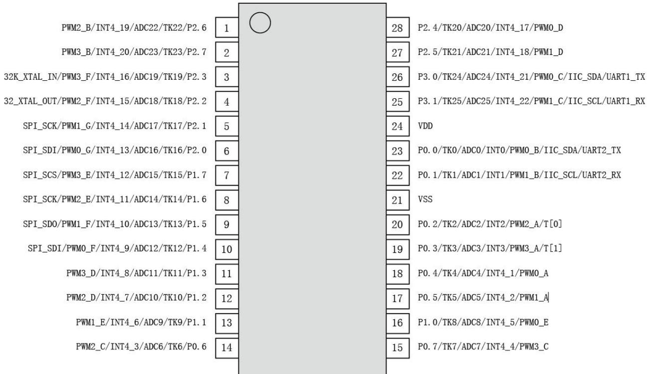
图 5-1-1 SOP28 封装引脚图
