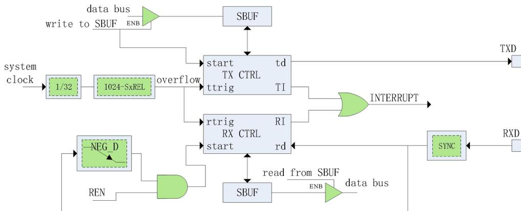
图 16-1-1 UARTx 工作原理示意图
