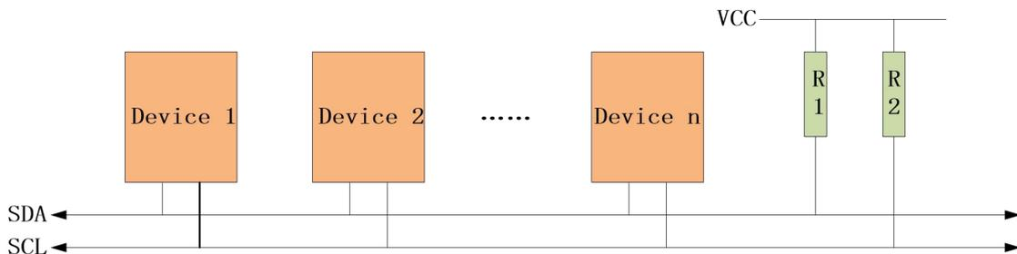
图 17-3-1 I<sup>2</sup>C 总线互连图
