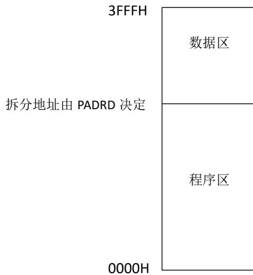
图 7-3-1 16K Flash 存储器结构
