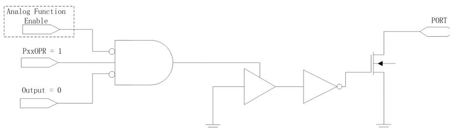
图 15-1-2 I/O 开漏模式结构示意图
