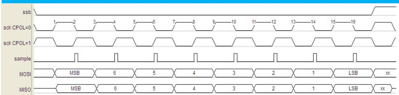
图 19-1-4 CPHA=1 时 SPI 时序图
