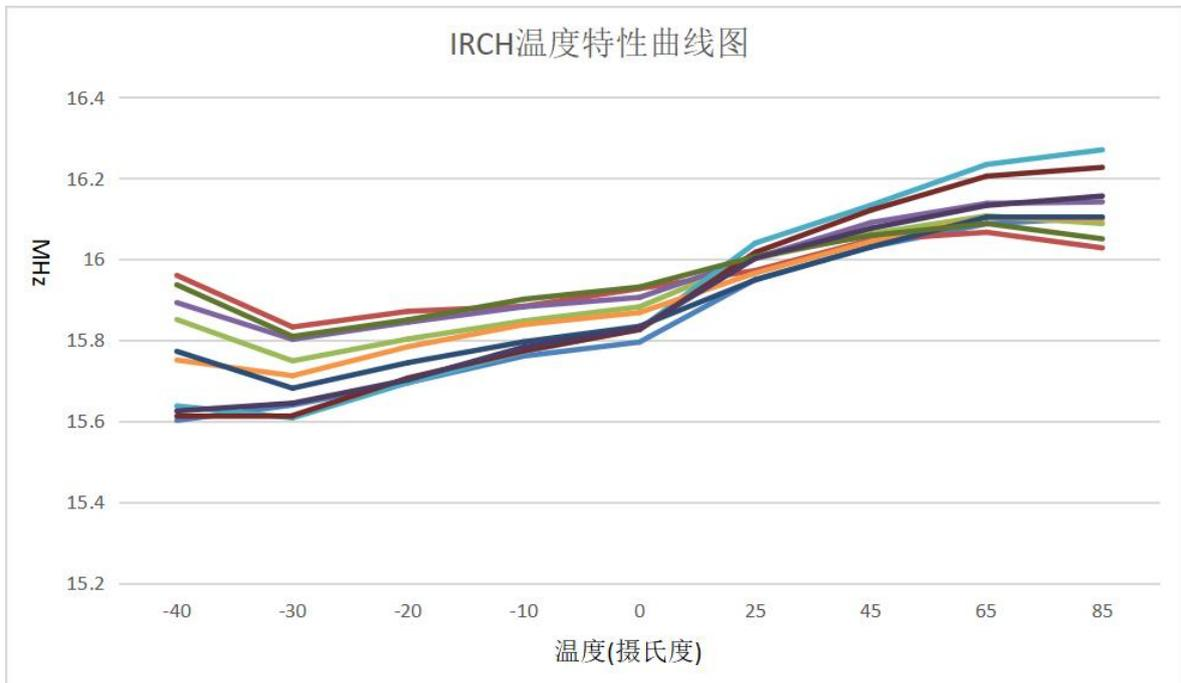
图 23-5-1 IRCH 温度特性曲线图
