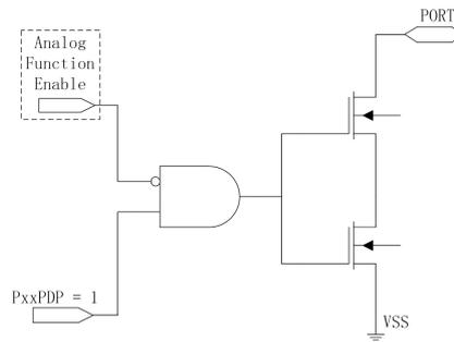
图 15-1-3 I/O 下拉模式结构示意图
